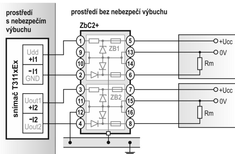
**Upozornění:** hodnota napájecího napětí  $+U_{cc}$  nesmí překročit hodnotu maximálního povoleného pracovního napětí Zenerovy bariéry ( $U_{pmax} = 26 \text{ V}$ )
