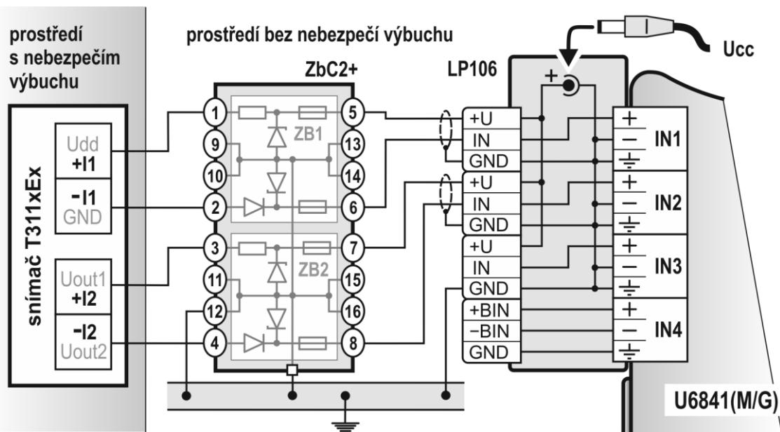
**Upozornění:** hodnota napájecího napětí **Ucc** nesmí překročit hodnotu maximálního povoleného pracovního napětí Zenerovy bariéry (Upmax = 26 V). Použijte stabilizovaný síťový adaptér A1941 (24 Vdc).
