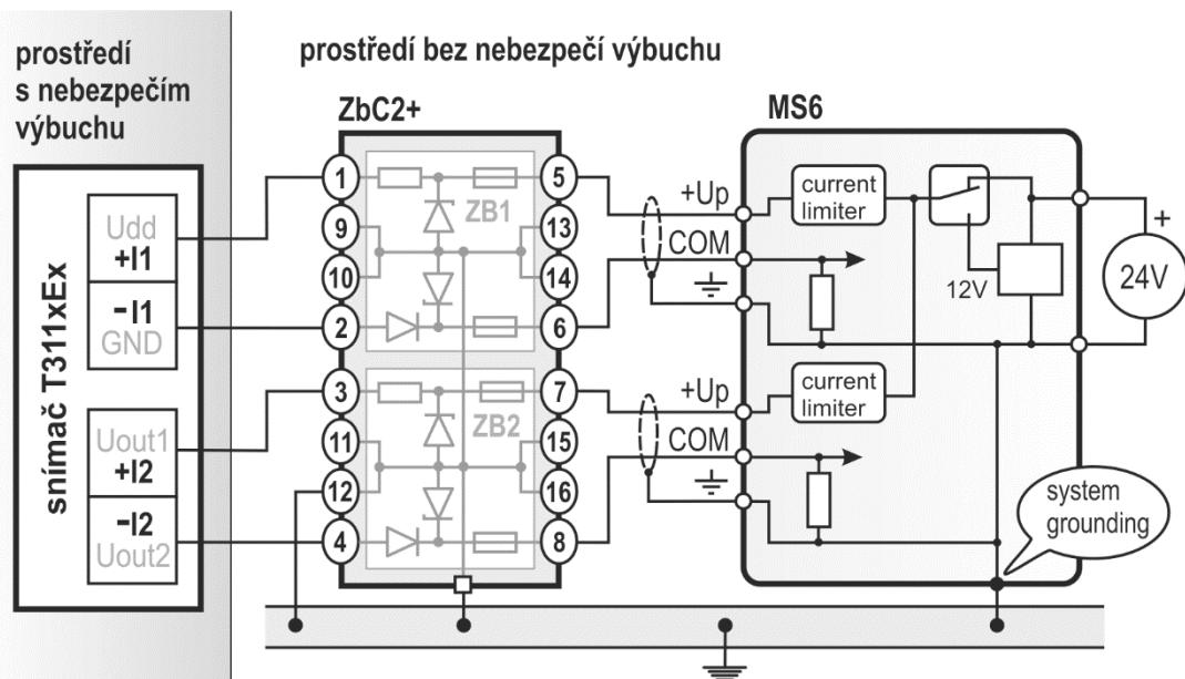
**Upozornění:** hodnota napájecího napětí ústředny nesmí překročit hodnotu maximálního povoleného pracovního napětí zenerovy bariéry (Uprmax = 26 V). Použijte stabilizovaný zdroj 24 Vdc z doporučeného příslušenství (pro napájení není vhodný nestabilizovaný zdroj A1759).
