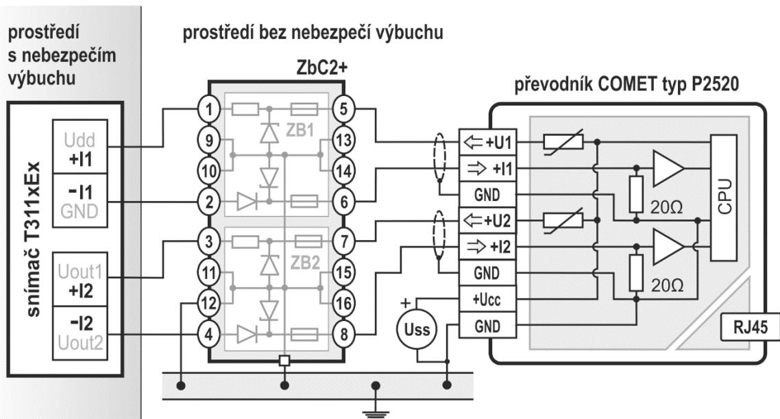
**Upozornění:** hodnota napájecího napětí +Uss nesmí překročit hodnotu maximálního povoleného pracovního napětí Zenerovy bariéry (Upmax = 26 V). Použijte stabilizovaný zdroj 24 Vdc z doporučeného příslušenství.
