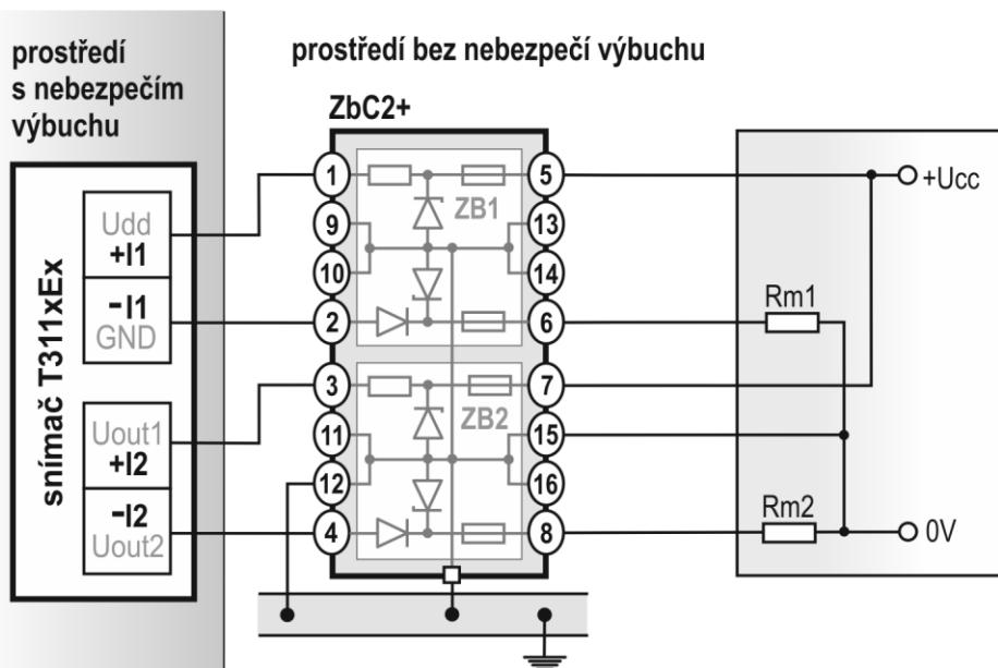
**Upozornění:** hodnota napájecího napětí +Ucc nesmí překročit hodnotu maximálního povoleného pracovního napětí Zenerovy bariéry (Upmax = 26 V)
