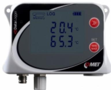
Datalogger je určen pro záznam teplot ze dvou externích sond Pt1000. Záznam je prováděn do energeticky nezávislé elektronické paměti. Údaje lze kdykoli přenést do osobního počítače přes rozhraní USB-C.
