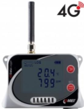
GSM datalogger je určen pro záznam teploty, vlhkosti, atmosférického tlaku a CO<sub>2</sub>. V případě překročení nastavených mezí umožnuje zasílání alarmových SMS a JSON zpráv přes 4G datové připojení. Měřené hodnoty mohou být zasílány do internetového úložiště [COMET Cloud](#), což je kompletní monitorovací, alarmovací a analytický systém.
