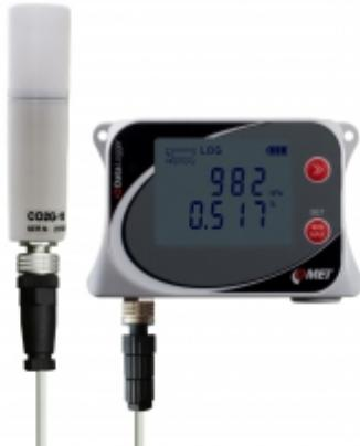
Bateriový datalogger s interním čidlem atmosférického tlaku a pro externí CO<sub>2</sub> sondu až **10 000ppm**. Při překročení nastavených mezí jsou alarmy indikovány pomocí LED, LCD a akusticky. Záznam je prováděn do energeticky nezávislé elektronické paměti. Údaje lze kdykoli přenést do osobního počítače přes rozhraní USB-C.
