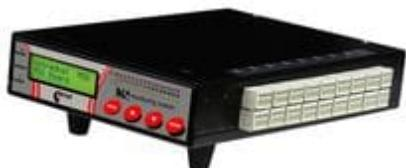
Kompletní řešení pro monitoring teploty, vlhkosti, tlaku, CO<sub>2</sub>, napětí, proudu, pulsů a dalších veličin. Univerzální konfigurovatelné vstupy a výstupy. Ke stolnímu použití s pryžovými nožičkami - viz Volitelné příslušenství.
